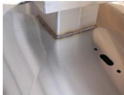
Spoina przed czyszczeniem
